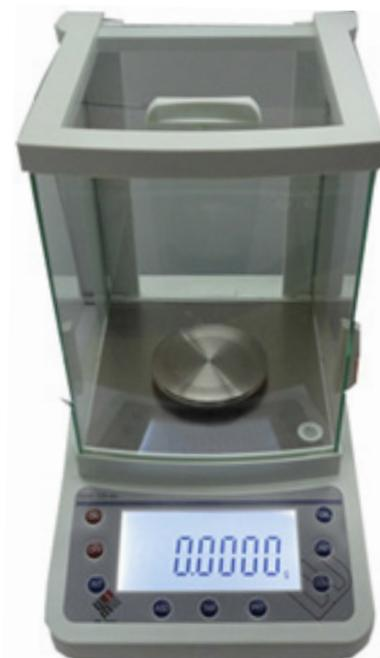
Avanzada tecnología basada en transductores de compensación electromagnética de nueva generación, que garantiza una óptima precisión pesada tras pesada.
